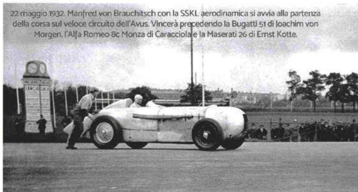
L'affusolata coda della SSKL aerodinamica disegnata da Reinhard von Koenig-Fachsenfeld ed eseguita con leghe leggere da Cannetter & Vetter. La vettura supera agevolmente i 200 km/h ed è adatta ai circuiti veloci, ma è soccombente negli altri.
