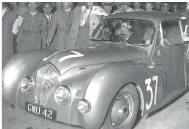
**Dati Tecnici:****Motore:** 4 cilindri.**Cilindrata totale:** 2.443 cc.**Potenza:** 104 cv a 4.500 giri/m.**Velocità:** 167 km/h.**Alimentazione:** aspirata, 2 carburatori S.U.**Telaio/carrozzeria:** berlina due porte.**Note:**
