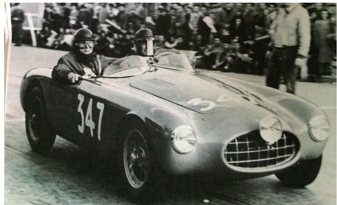
**Dati Tecnici:****Motore:** 4 cilindri.**Cilindrata totale:** 1.089 cc.**Potenza:** 90 cv.**Velocità:** 185 km/h.**Alimentazione:** aspirata, 2 carburatori doppiocorpo Weber.**Telaio/carrozzeria:** tubolare/berlinetta.**Note:**
